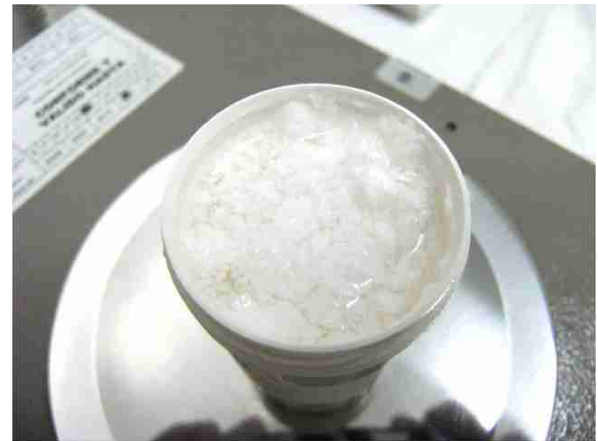
Separación de fases al cabo de 24 horas de una emulsión no iónica con ácido salicílico a alta concentración.
