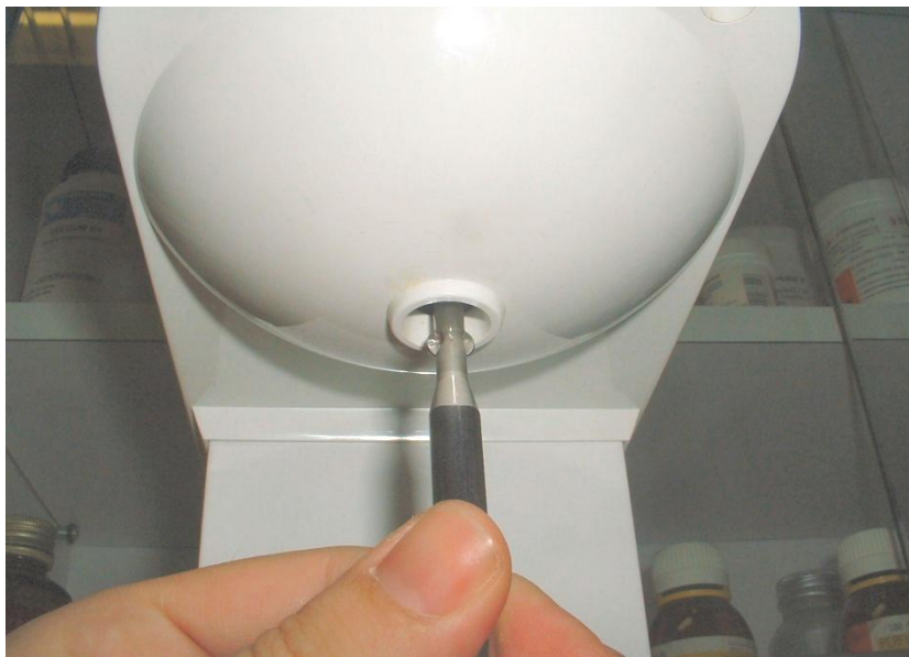
Figura 9. Acoplamiento de la varilla en el aparato agitador.
