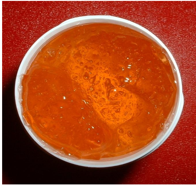
Figura 6. Gel de Carbopol 940® con hidroquinona al 2 % obtenido por neutralización con trietanolamina. Al cabo de unos minutos de haber sido elaborado se produce coloración anaranjada por oxidación de la hidroquinona.
